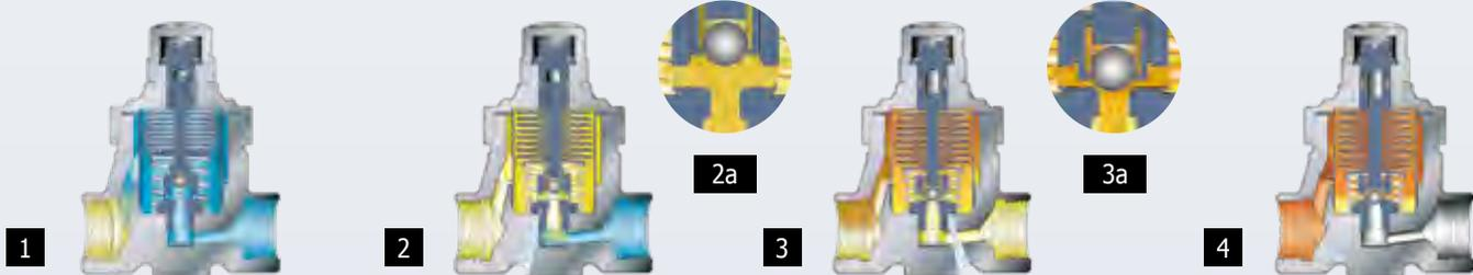
1 Beim Anfahren drückt eine Feder den Ventilhalter nach oben. Die Bimetalle sind flach. Das Ventil ist voll geöffnet und das kalte Kondensat kann ungehindert abfließen.
