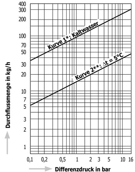
$\Delta t$  ist die Temperaturdifferenz zwischen der tatsächlichen Temperatur des abgeleiteten Kondensats und der eingestellten Öffnungstemperatur des Ableiters.
