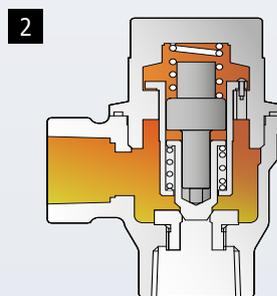
2 Wenn die Temperatur des Kondensats ansteigt, beginnt sich das Thermo-Element auszudehnen und zwingt das Ventil, sich nach unten zu bewegen. Wenn die Kondensattemperatur über der Öffnungstemperatur (Typ-abhängig) liegt, schließt das Ventil den Sitz vollständig.
