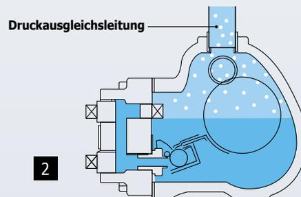
Beim Anfahren tritt Kondensat in den Kondensatableiter ein. Der Schwimmer hebt sich und das Kondensat wird abgeleitet. Luft, die normalerweise zusammen mit dem Kondensat in den Kondensatableiter einströmt, sammelt sich im oberen Teil des Gehäuses. Um Luftblasen zu vermeiden, wird der obere Teil des Kondensatableiters über eine Druckausgleichsleitung mit dem Behälter verbunden.
