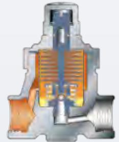
Wenn im Ableiter die Einstelltemperatur erreicht wird, schließt der Ventilhalter die Öffnungen des Führungsstückes. Gleichzeitig schließt das Ventil den Sitz. Der Ableiter staut das Kondensat zurück. Dadurch sinkt die Kondensattemperatur im Ableiter und das Ventil öffnet sich leicht. Die Positionen des Ventilhalters und des Ventils pegeln sich auf ein Niveau ein (3). Das Kondensat wird kontinuierlich abgeleitet.
