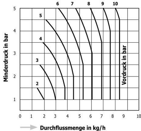
Minimale Druckdifferenz zwischen Vordruck und Nachdruck
