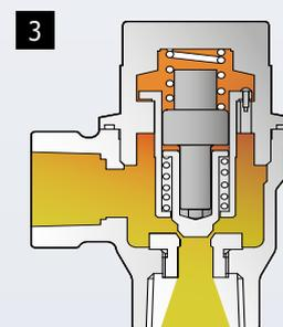
3 Bei sinkender Kondensattemperatur schrumpft das Thermo-Element und das Ventil wird geöffnet. Kondensat wird kontinuierlich mit einer stabilen Temperatur abgeführt.
