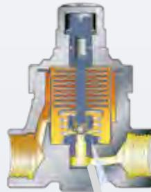
Bei weiterer Temperaturerhöhung nahe der Einstelltemperatur biegen sich die Bimetalle weiter aus. Der Ventilhalter wird mit dem Ventil weiter in Richtung Sitz bewegt.
