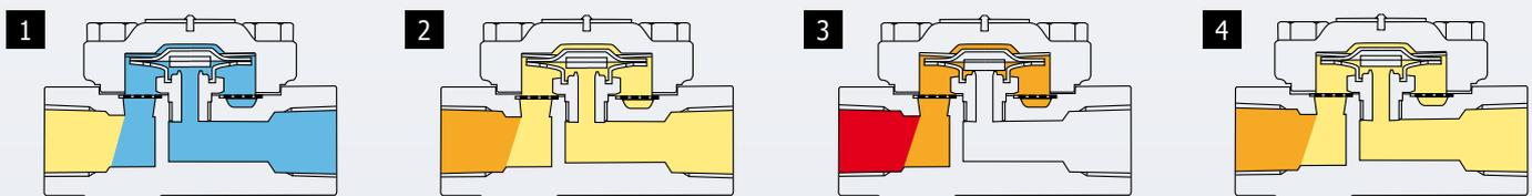
1 Beim Anfahren der Anlage, wenn kaltes Kondensat abgeleitet werden muss, dehnt sich die Kapsel nicht aus und der Kondensatableiter ist geöffnet.
