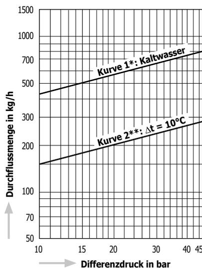
$\Delta t$  = ist die Temperaturdifferenz zwischen der tatsächlichen Temperatur des abgeleiteten Kondensats und der eingestellten Öffnungstemperatur des Ableiters.
