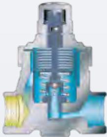
Beim Anfahren drückt die Feder 1 den Ventilhalter nach oben. Die Bimetalle sind flach. Das Ventil ist voll geöffnet und das kalte Kondensat kann ungehindert abfließen.
