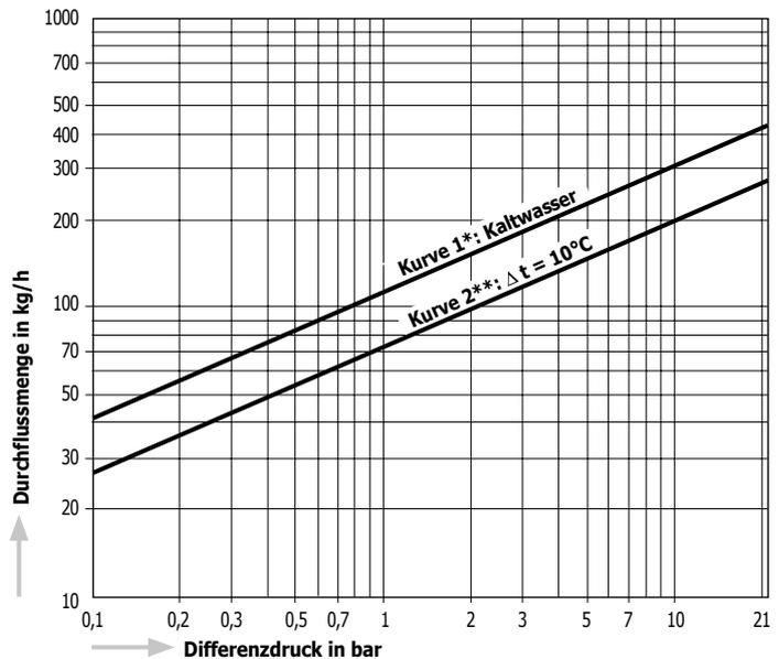
$\Delta t =$  ist die Temperaturdifferenz zwischen der tatsächlichen Temperatur des abgeleiteten Kondensats und der eingestellten Öffnungstemperatur des Ableiters.
