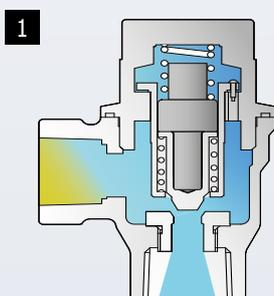
1 Beim Anfahren ist der Ventilschaft weit oben und das Ventil vollständig geöffnet. Kaltes Kondensat und Luft werden praktisch vollständig abgeführt.
