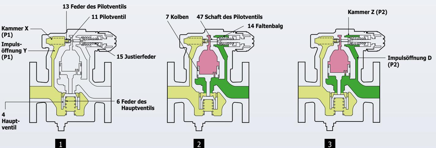
Vor dem Einstellen des Minderdrucks muss der grüne Griff im Uhrzeigersinn gedreht werden (bis der Griff sich frei bewegt), um die Justierfeder (15) zu entlasten. In dieser Position sind das Hauptventil (4) durch die Kraft der Feder (6) und das Pilotventil (11) durch die Kraft der Feder Nr. (13) geschlossen. Wenn Dampf in den Druckminderer strömt, füllt sich die Kammer X über die Impulsöffnung Y mit Dampf.
